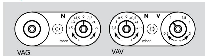
Если горелка эксплуатируется при минимальной нагрузке газовоздушная смесь может регулироваться параллельным перемещением расходной характеристики при вращении регулировочного винта „N“.
