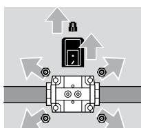
Обеспечьте достаточное место для монтажа фланцев и привода.
