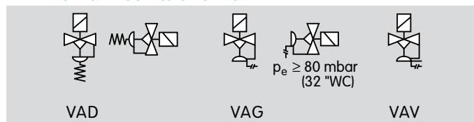
VAD, VAG: Монтажное положение вертикальное или горизонтальное, (для VAG горизонтальное положение, только при  $p_e \geq 80$  мбар), положение вниз электромагнитом не допускается.
